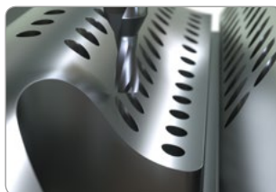
Bohrungen bis 60° Neigungswinkel in konvexe Oberflächen.
